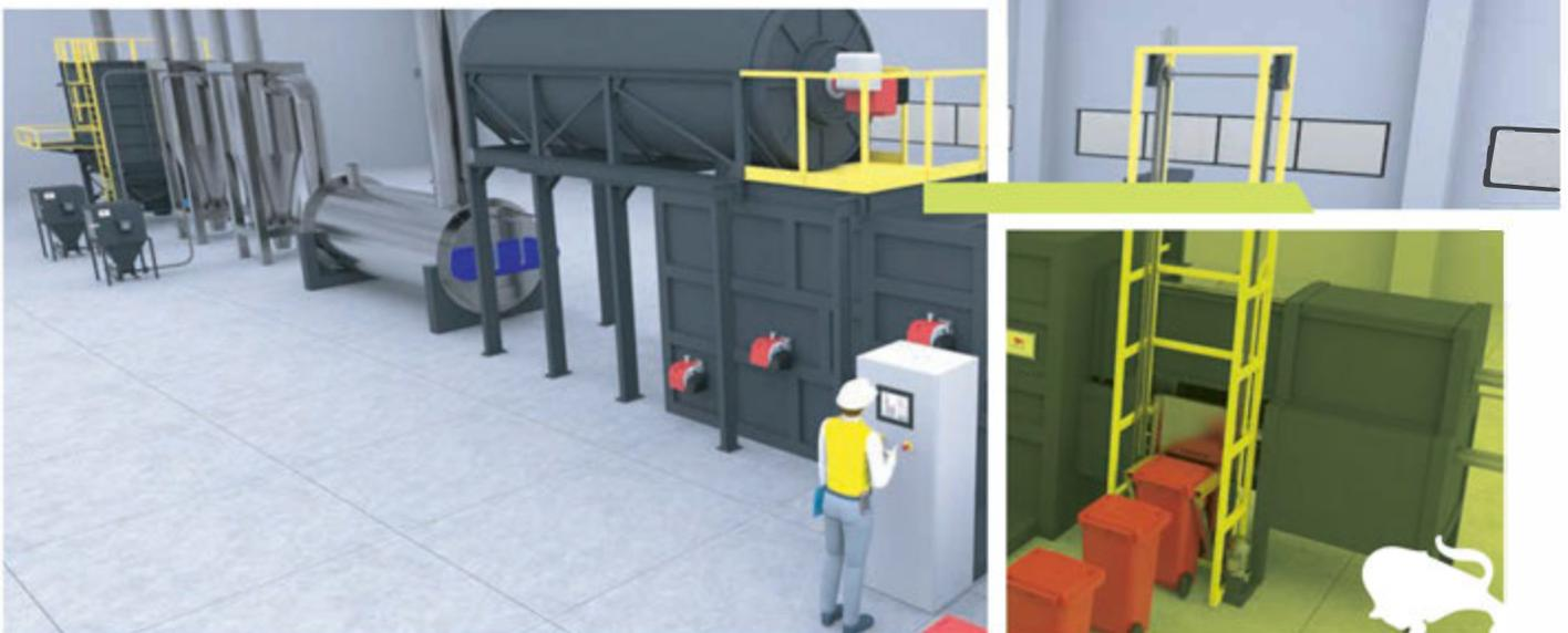
La serie ECOTEC incluye incineradores de diferentes tamaños y capacidades hasta una capacidad máxima de 1.000 kg/h; estos hornos se han diseñado para instalarse en varias unidades que funcionan conjuntamente, con el fin de satisfacer mayores necesidades de eliminación. Gracias a los sofisticados PLC con los que están equipados, es posible tener un control total en cualquier momento, incluso a distancia de todo el proceso de incineración en las plantas Ecotec.
